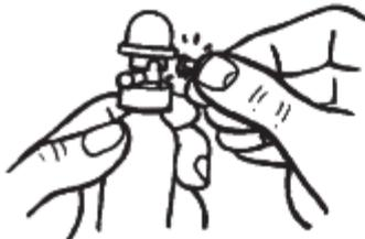
**3)** Conectar el aplicador firmemente al tubo de descarga del aerosol y alinear la muesca situada debajo de la cabeza dosificadora con el tubo de descarga.
